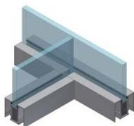
Sur l'ensemble des angles, réaliser les raccords verticaux des volumes vitrés par joints collés en ruban adhésifs VHB 3M transparents (4918 ép. 2mm) et primaire d'accrochage 3M 94.
