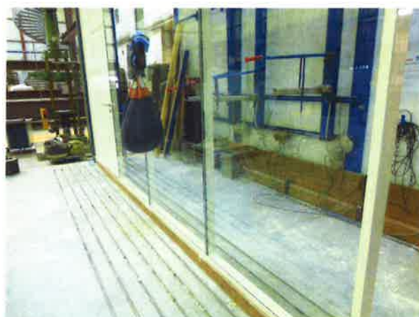
Résultat de l'essai de choc M50/900J à mi-largeur à 1 m de hauteur : Couvre joint déclipsés
