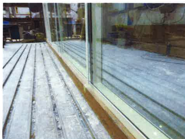
Résultat essai de choc M50/900J sur le montant
