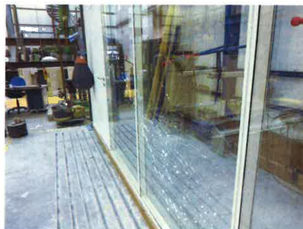
Résultat : Essai de choc M50/900J à mi-largeur à 1 m de hauteur :
