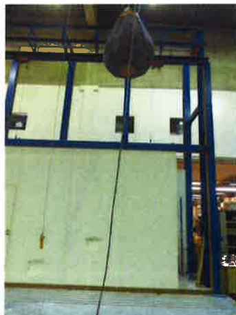
Essai de choc M50/900J sur le montant
