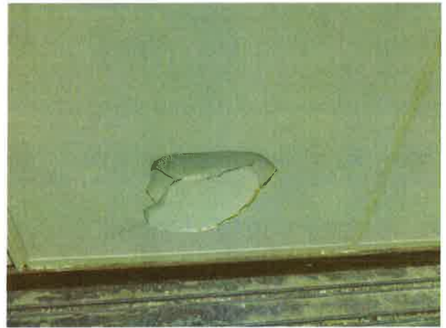
Résultat de l'essai de choc M50/700J sur la traverse invisible
