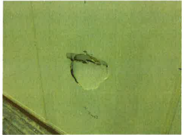
Résultat de l'essai de choc M50/900J à mi-largeur à 1 m
