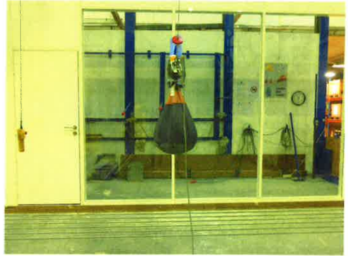
Essai de choc M50/900J sur le montant
