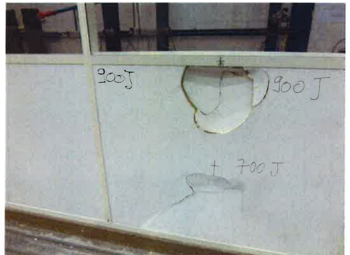
Résultat de l'essai de choc M50/700J sur le remplissage
