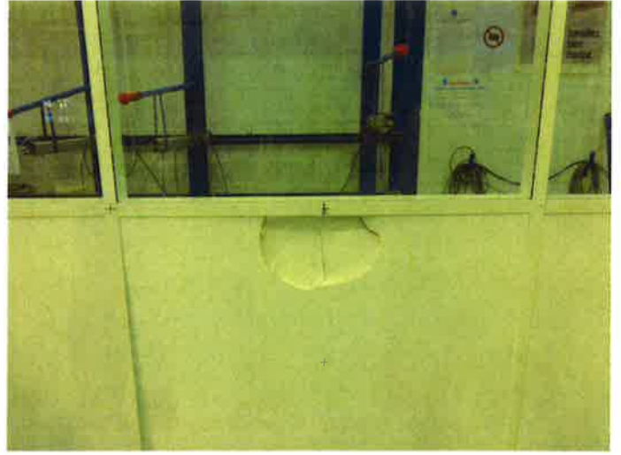
Résultat de l'essai de choc M50/900J sur la traverse
